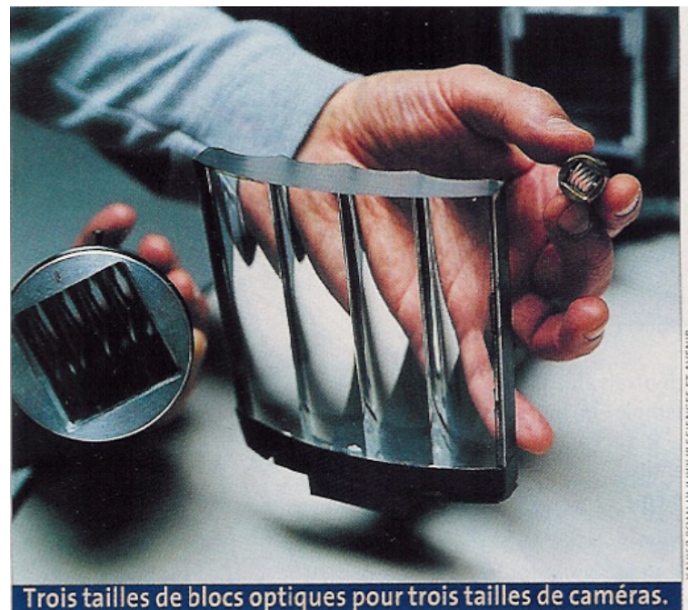
FIG. 1.34 – Lentilles utilisées pour l'alioscopie ( Source : Sciences et Avenir )
