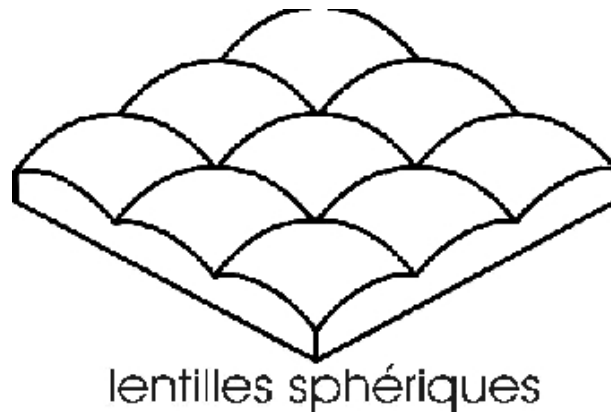
FIG. 1.27 – Schéma des lentilles imaginées par G. Lippmann
